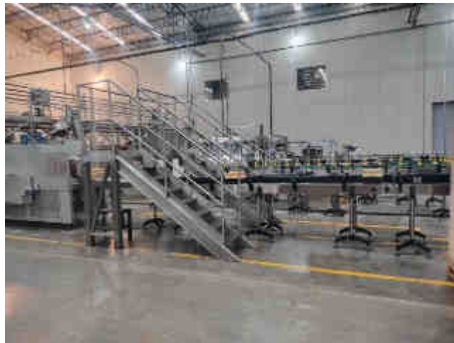
Plataforma de acceso operacional línea 2
